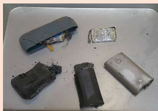
発火の原因となった リチウムイオン電池
